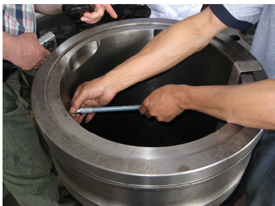
Рис. 9. Эрозионное разрушение поверхности втулки в местах водяного охлаждения Fig. 9. Cylinder liner surface erosive destruction from water side
