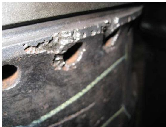
Рис. 9. Эрозионное разрушение поверхности втулки в местах водяного охлаждения Fig. 9. Cylinder liner surface erosive destruction from water side
