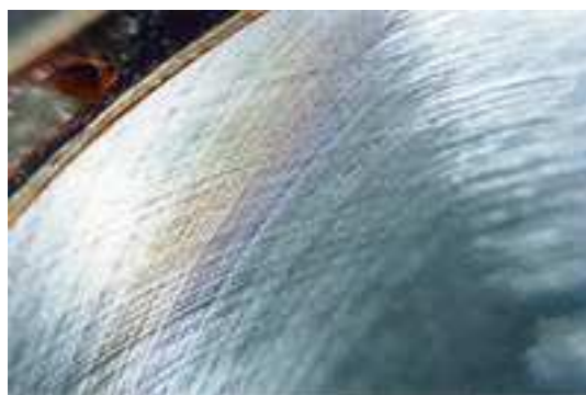
Рис. 12. Цилиндрическая втулка после хонингования Fig. 12. The cylinder bore honed
